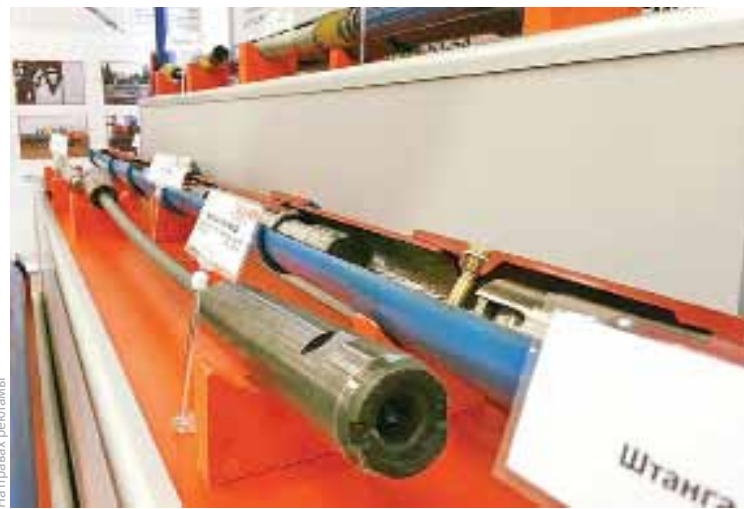
Канатная штанга устойчива к повышенным нагрузкам — в подвешенном состоянии способна выдерживать нагрузку до 40 тонн
