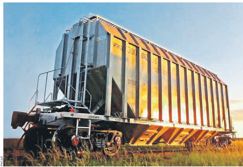
Алюминиевый вагон-хоппер, созданный «Арконик Россия» совместно с «РМ Рейл» и ОК «Русал», — это, конечно, прорыв для российских железных дорог, поскольку в Европе и США алюминий давно один из основных конструктивных материалов для производства железнодорожного транспорта
