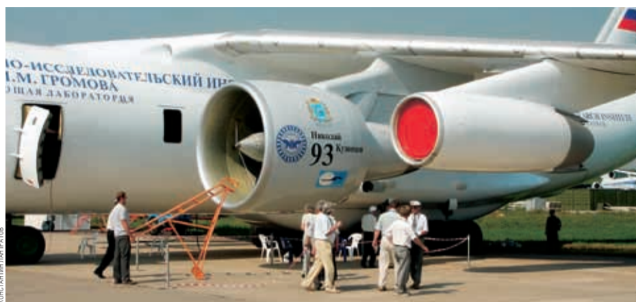
ЕСЛИ НК-93 УДАТСЯ ДОВЕСТИ ДО СЕРИЙНОГО ПРОИЗВОДСТВА, ЕГО МОЖНО БУДЕТ УВИДЕТЬ НЕ ТОЛЬКО ПОД КРЫЛОМ ЛЕТАЮЩЕЙ ЛАБОРАТОРИИ ИЛ-76ЛЛ (НА ФОТО), НО И НА ИЛ-196 И ТУ-304
