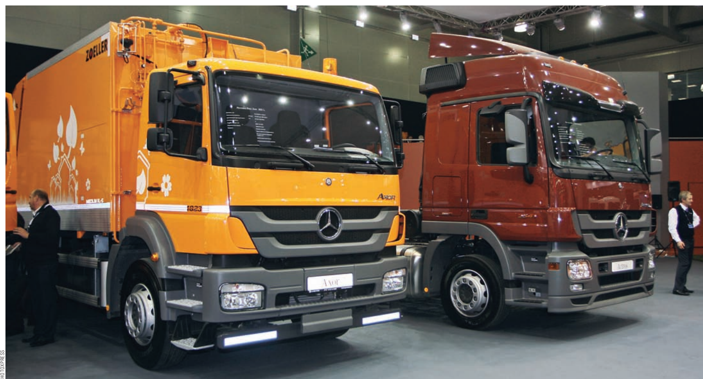
ЭКСПЕРИМЕНТАЛЬНЫЕ МАГИСТРАЛЬНЫЕ СЕДЕЛЬНЫЕ ТЯГАЧИ СЕРИИ 5490. ОДИН ИЗ НИХ — С ПЕРЕЛИЦОВАННОЙ КАБИНОЙ ОТ MERCEDES-BENZ AXOR
