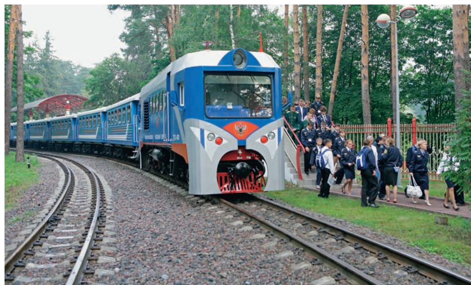
Капитально отремонтированный и модернизированный тепловоз ТУ2-078 на малой московской железной дороге
