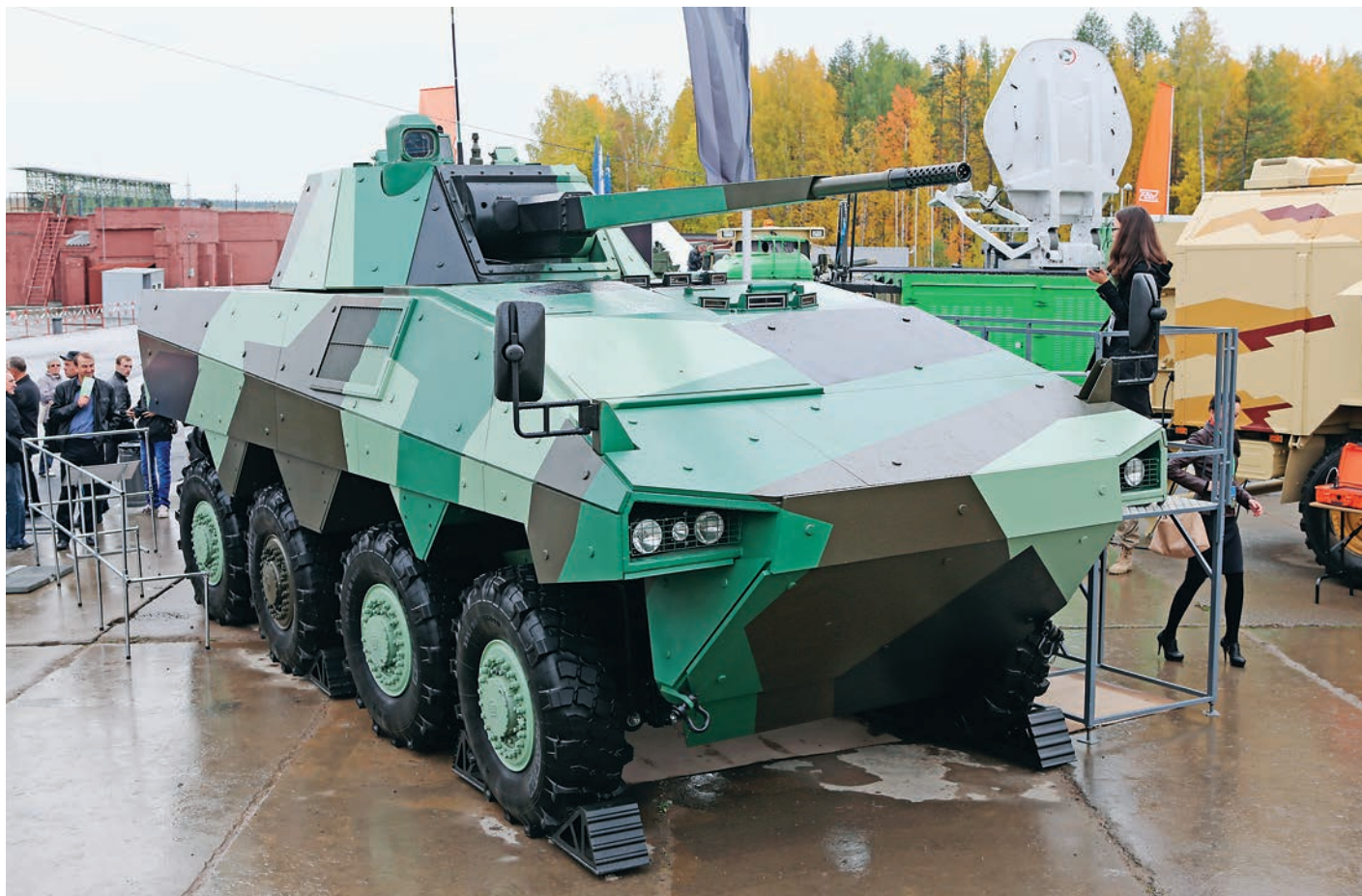
«АТОМ» СПОСОБЕН РАЗВИВАТЬ МАКСИМАЛЬНУЮ СКОРОСТЬ ПО ШОССЕ ДО 100 КИЛОМЕТРОВ В ЧАС С ЗАПАСОМ ХОДА ДО 750 КИЛОМЕТРОВ
