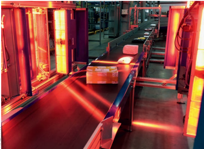
СИСТЕМА ОПТИЧЕСКОГО РАСПОЗНАВАНИЯ ТЕКСТА ПОЗВОЛЯЕТ СЧИТЫВАТЬ ИНФОРМАЦИЮ, РАЗМЕЩЕННУЮ НА ОБОЛОЧКЕ ОТПРАВЛЕНИЙ, ВНЕ ЗАВИСИМОСТИ ОТ ЕЕ ФОРМАТА. ОНА СПОСОБНА РАСШИФРОВЫВАТЬ И РУКОПИСНЫЙ ТЕКСТ
