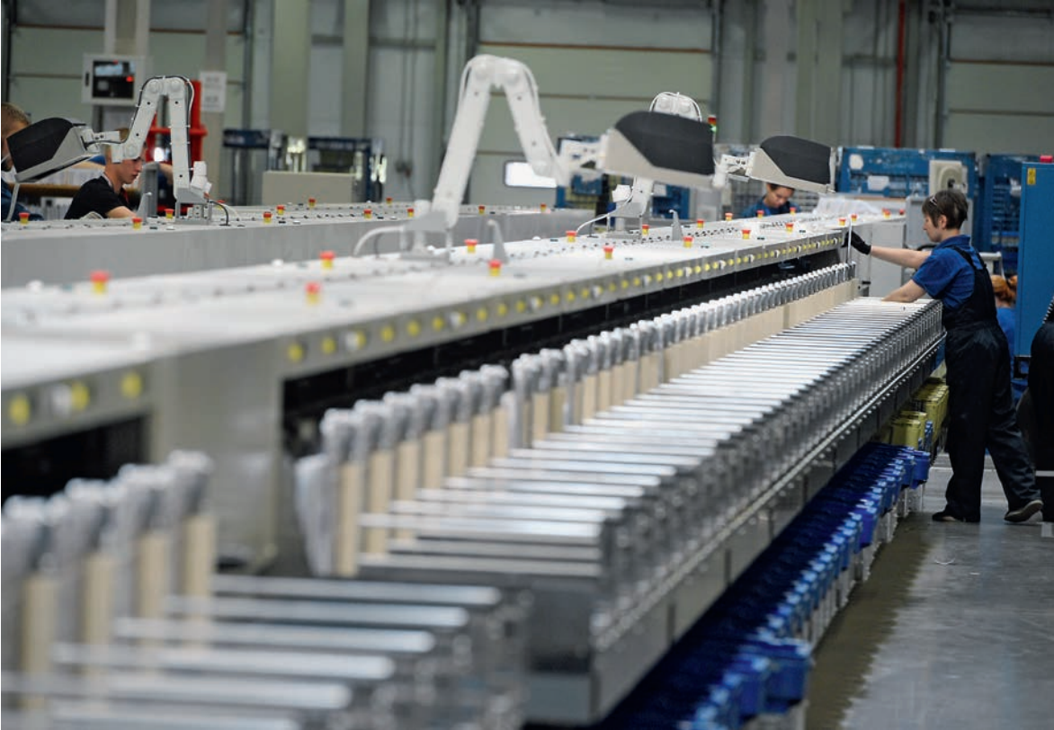
СОВРЕМЕННЫЕ СОРТИРОВОЧНЫЕ МАШИНЫ ОБРАБАТЫВАЮТ ПИСЬМЕННУЮ КОРРЕСПОНДЕНЦИЮ СО СКОРОСТЬЮ 12 ПИСЕМ В СЕКУНДУ
